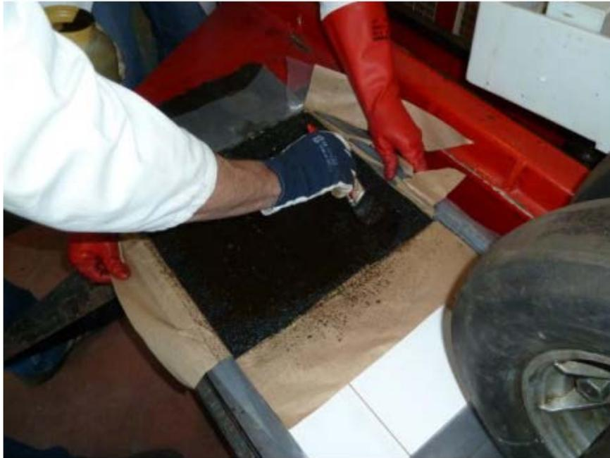
**Figure C : Application couche émulsion tack coat sur l'échantillon**
