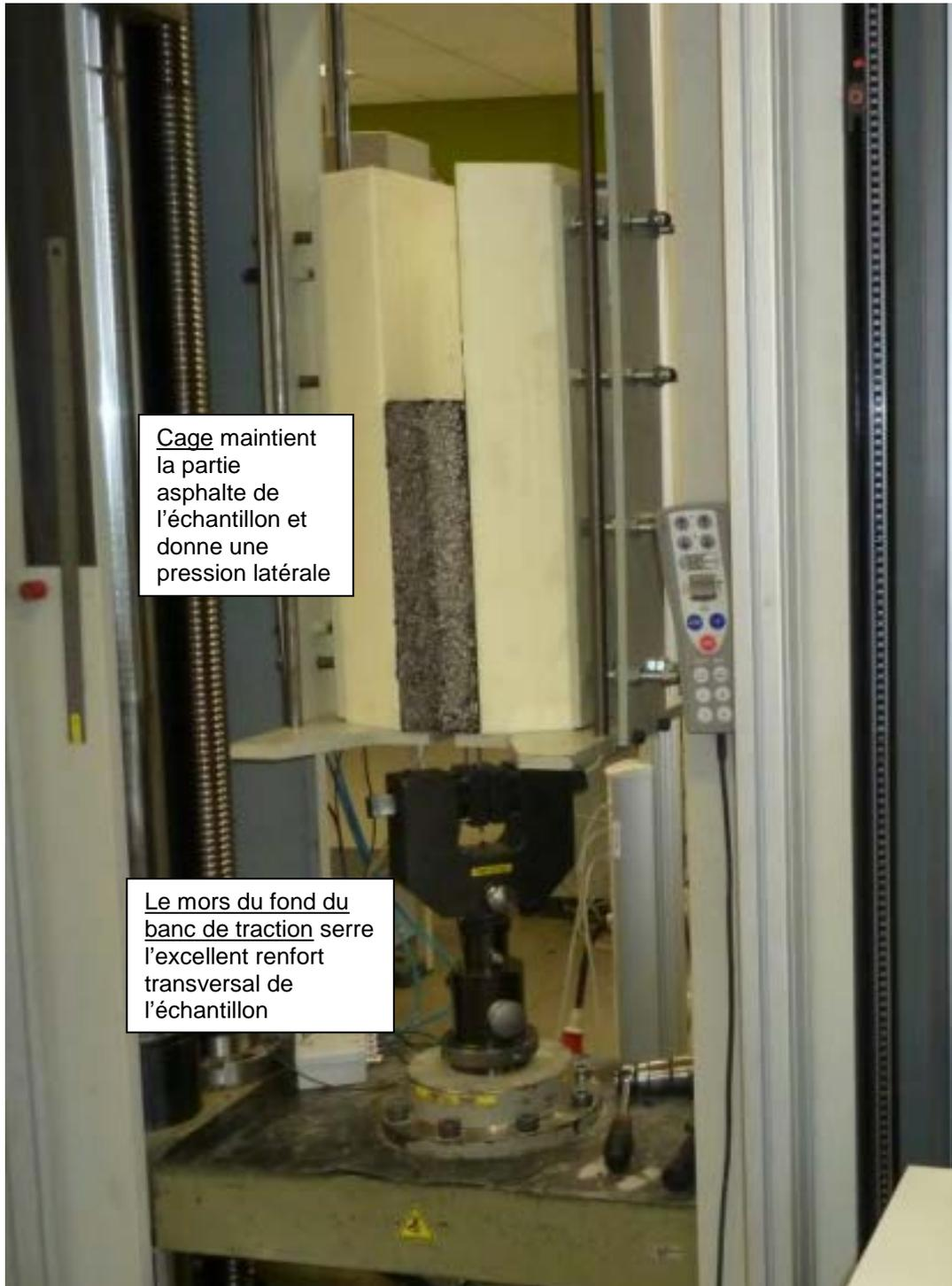
**Figure 3 : Echantillon intégré dans le banc de traction**
