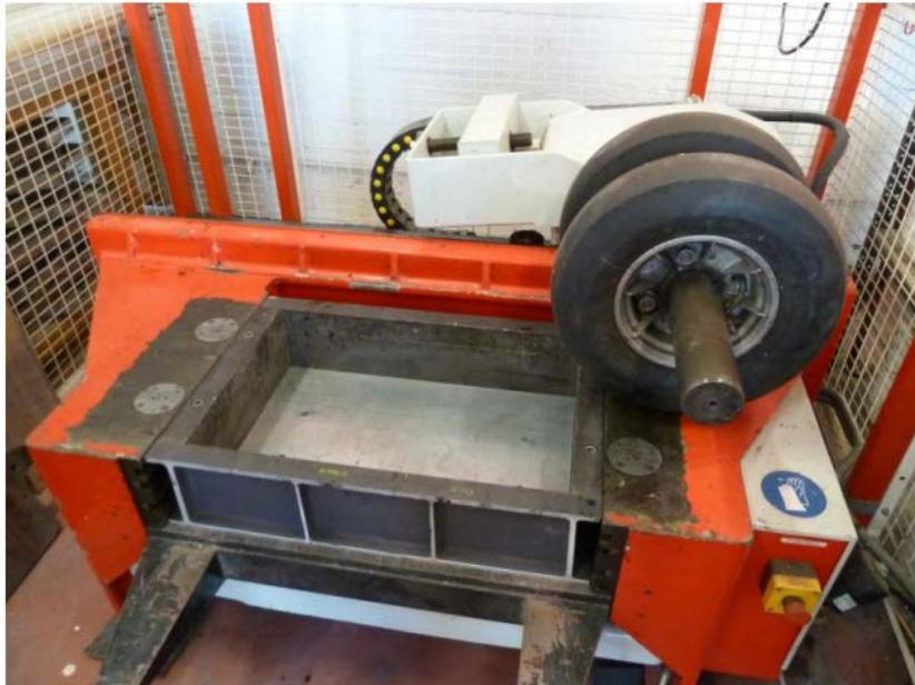
**Figure A : Exemple de la machine de compactage de plaque avec moule, pour compactage d'asphalte suivant la norme NBN EN 12697-33**
