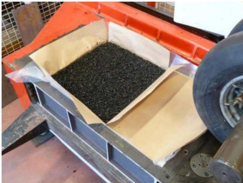
**Figure B : Echantillon après compactage de la couche de sol asphalte (note : à droite dans le moule pas d'asphalte pour d'excellents renforts transversaux)**
