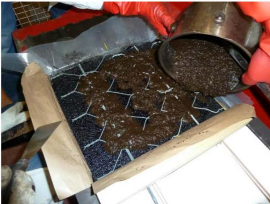
**Figure D : Application couche slurry seal (note : 2 échantillons de treillis d'armatures en acier sont appliqués)**
